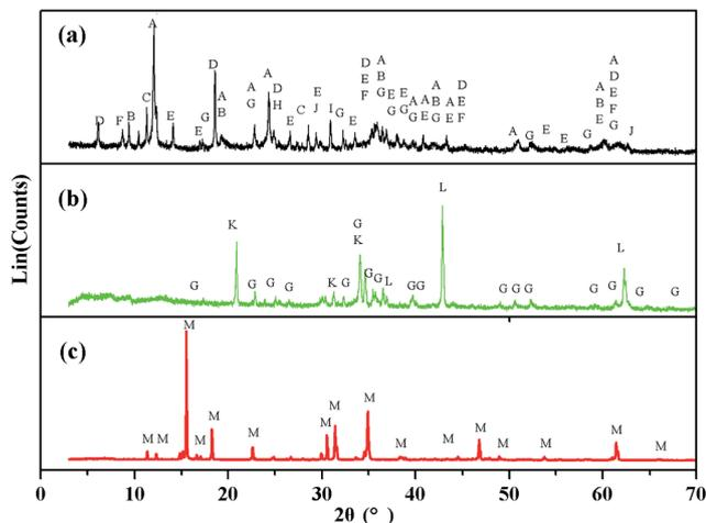
Fig. 3 XRD pattern of (a) Kuandian ores, (b) samples roasted at 950 °C and (c) the crystals. (A)  $Mg_6[Si_4O_{10}](OH)_8$ ; (B)  $Mg_3[Si_4O_{10}](OH)_2$ ; (C)  $Ca_2Mg_5Si_8O_{22}(OH)_2$ ; (D)  $Mg_3[Si_4O_{10}](OH)_2Mg_3(OH)_6$ ; (E)  $Mg_2(OH)[B_2O_4(OH)]$ ; (F)  $KAl_2(AlSi_3O_{10})(OH)_2$ ; (G)  $Mg_2SiO_4$ ; (H)  $SiO_2$ ; (I)  $CaMg(CO_3)_2$ ; (J)  $Fe_3O_4$ ; (K)  $Na_2B_4O_7$ ; (L)  $MgO$ ; (M)  $Na_2B_4O_7 \cdot 10H_2O$ .
