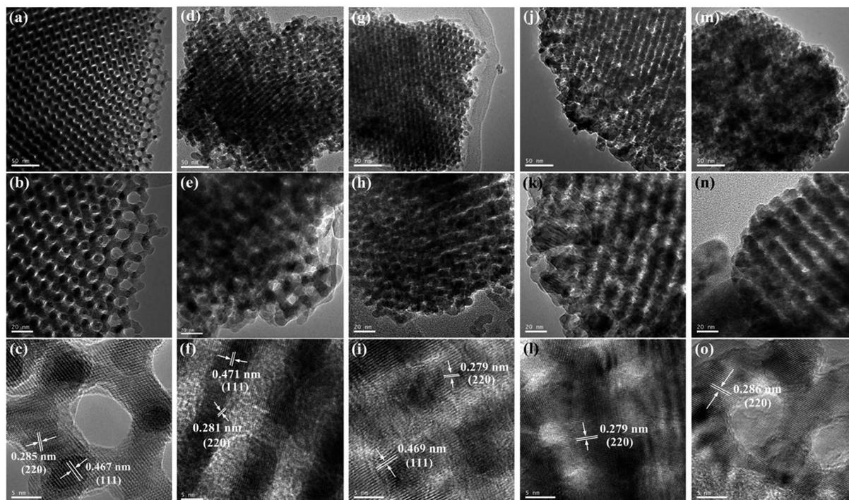
Fig. 2 TEM and HR-TEM images of OM- $\text{Co}_3\text{O}_4$  and  $\text{Co}_3\text{O}_4$ -composite spinels. (a)–(c) OM- $\text{Co}_3\text{O}_4$ ; (d)–(f)  $\text{Co}_3\text{O}_4$ - $\text{CoFe}_2\text{O}_4$ ; (g)–(i)  $\text{Co}_3\text{O}_4$ - $\text{CoMn}_2\text{O}_4$ ; (j)–(l)  $\text{Co}_3\text{O}_4$ - $\text{CuCo}_2\text{O}_4$ ; (m)–(o)  $\text{Co}_3\text{O}_4$ - $\text{NiCo}_2\text{O}_4$ .
