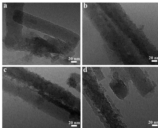
Fig. 4 TEM images of eHA@Co<sup>2+</sup>: (a) HA/HCl-18 h/Co<sup>2+</sup>-0.5 : 1, (b) HA/HCl-18 h/Co<sup>2+</sup>-1 : 1, (c) HA/HCl-18 h/Co<sup>2+</sup>-2 : 1 and (d) HA/HCl-18 h/Co<sup>2+</sup>-4 : 1.
