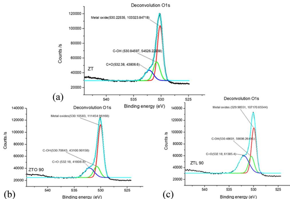
Fig. 6 Deconvolution para el O 1s de las muestras (a) ZT, (b) ZTO90 y (c) ZTL90.
