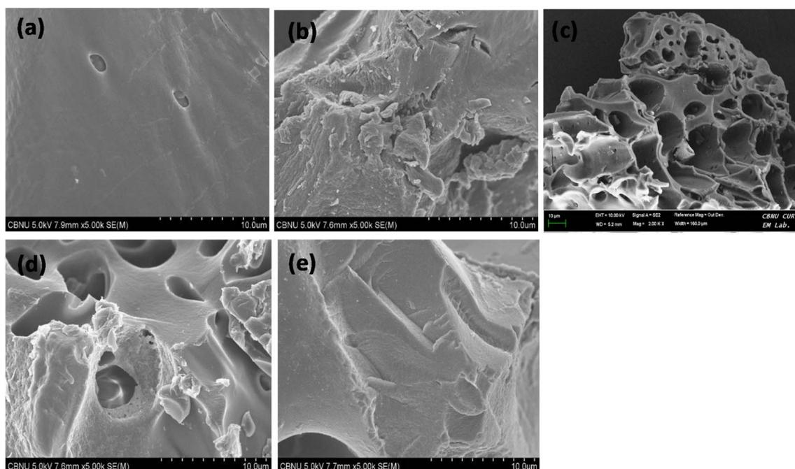
Fig. 1 SEM images of (a) RSB (b) CSB (c) Hg(II)-CSB (d) CXSB and (e) Hg(II)-CXSB.
