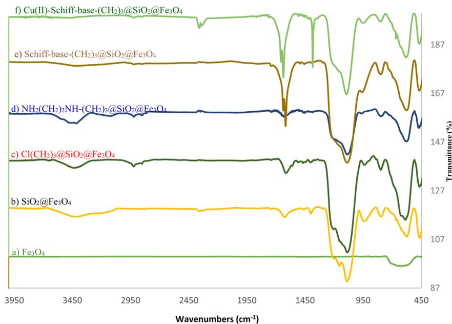
Fig. 1 FT-IR spectra of (a)  $\text{Fe}_3\text{O}_4$ , (b)  $\text{SiO}_2@Fe_3O_4$ , (c)  $\text{Cl}(\text{CH}_2)_3@SiO_2@Fe_3O_4$ , (d)  $\text{NH}_2(\text{CH}_2)_2\text{NH}-(\text{CH}_2)_3@SiO_2@Fe_3O_4$ , (e) Schiff-base- $(\text{CH}_2)_3@SiO_2@Fe_3O_4$ , and (f) Cu(II)-Schiff-base- $(\text{CH}_2)_3@SiO_2@Fe_3O_4$
