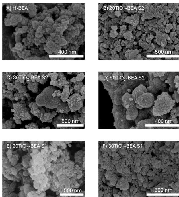
**Fig. 5** SEM images of the different composites: A) H-BEA, B) 20TiO<sub>2</sub>-BEA S2, C) 30TiO<sub>2</sub>-BEA S2, D) 50TiO<sub>2</sub>-BEA S2, E) 20TiO<sub>2</sub>-BEA S1 and F) 30TiO<sub>2</sub>-BEA S1 samples.
