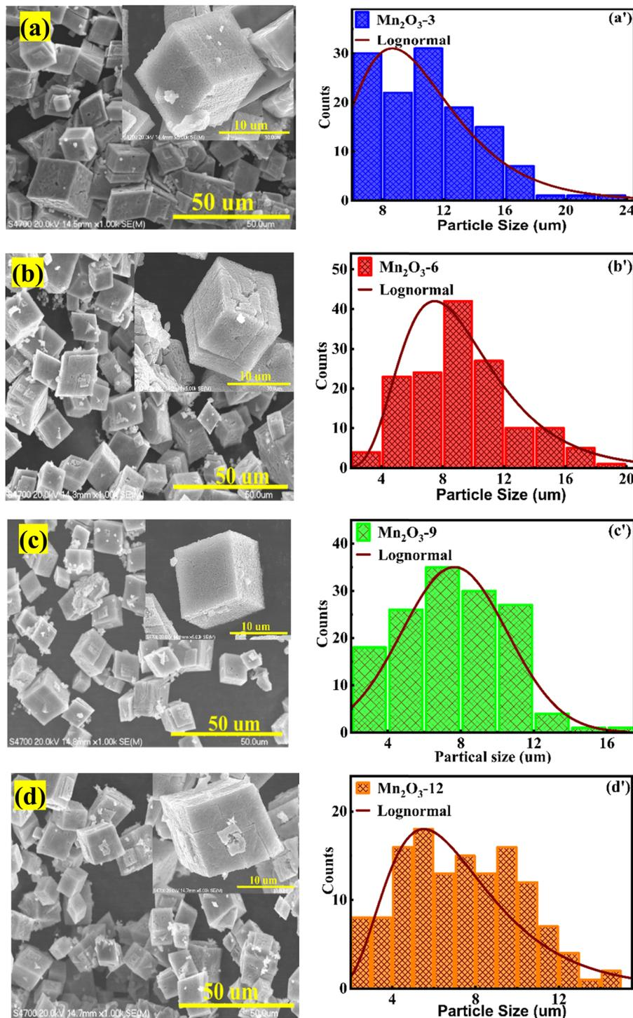
Fig. 3 FESEM images of (a)  $\text{Mn}_2\text{O}_3\text{-3}$ , (b)  $\text{Mn}_2\text{O}_3\text{-6}$ , (c)  $\text{Mn}_2\text{O}_3\text{-9}$ , (d)  $\text{Mn}_2\text{O}_3\text{-12}$ , and (a')–(d') histograms with log-normal distribution of length of  $\text{Mn}_2\text{O}_3$  particles.
