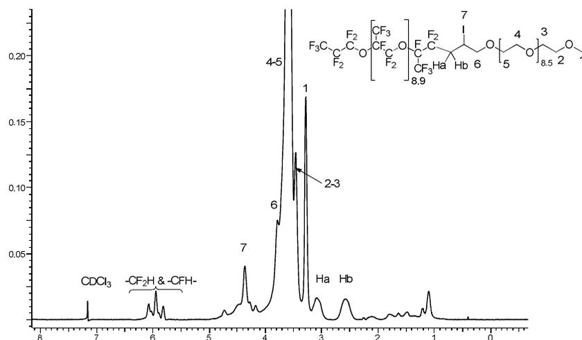
Figure 3:  $^1\text{H}$ -NMR spectra of A)  $\text{CH}_2=\text{CH}-\text{CH}_2\text{O}(\text{CH}_2\text{CH}_2\text{O})_{9.5}\text{CH}_3$ , allyl-PEG-OCH<sub>3</sub> and B)  $\text{F}[\text{C}(\text{CF}_3)\text{CF}_2\text{O}]_{8.9}\text{CF}(\text{CF}_3)\text{CF}_2\text{CH}_2\text{CHICH}_2\text{O}(\text{CH}_2\text{CH}_2\text{O})_{9.5}\text{CH}_3$ .
