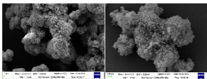
Fig. 12 HR-SEM image of Fe<sub>3</sub>O<sub>4</sub>.
