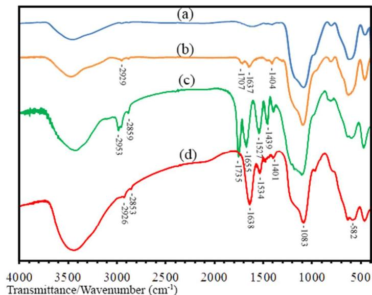
**Fig. 1.** FT-IR spectra of MNP (a), MNP@MPS (b), MNP@PMA (c) and MNP@PDMA (d)
