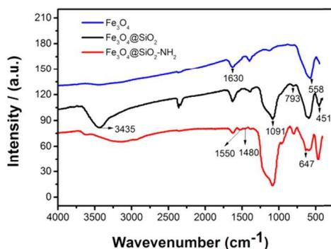
Figure 2 FT-IR spectrum of  $\text{Fe}_3\text{O}_4$ ,  $\text{Fe}_3\text{O}_4@\text{SiO}_2$  and  $\text{Fe}_3\text{O}_4@\text{SiO}_2\text{-NH}_2$ .
