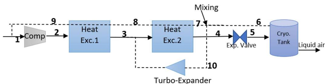
Fig. 5 Kapitza air liquefaction cycle.
